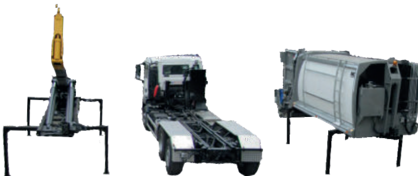
Kaoussis CRV2000 Wechselsystem (Kehrichtaufbau, Hakengerät)
