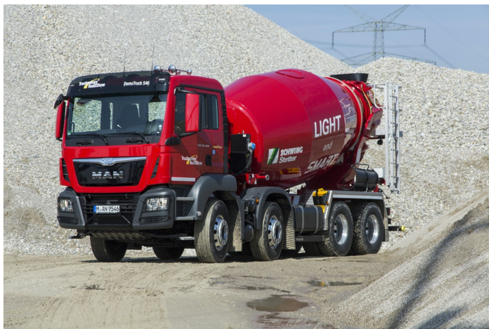
Un classico dell'edilizia: il MAN TGS 32.400 8x4 BB come autobetoniera
