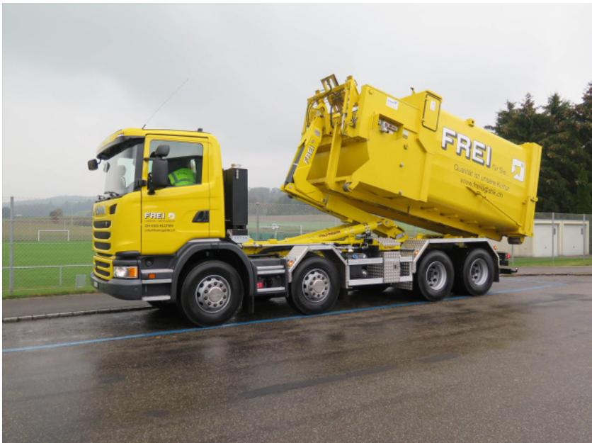
Le nouveau Scania G410 CB 8x4 dispose d'un dispositif à crochet performant de l'entreprise Walser AG (Palfinger).
