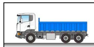
Livré prêt à l'emploi en sortie d'usine, ce camion-benne de 16 m<sup>3</sup> à trois essieux affiche un PTC de 39 tonnes et une imposante charge utile de 24 tonnes. Sa grande capacité de chargement et sa manœuvrabilité exceptionnelle font de ce camion un substitut intéressant aux tombereaux. Il est également disponible en variante 8x4 avec PTC de 56 tonnes. Plus de 4 000 de ces camions-bennes 6x4 et 8x4 ont été livrés sur des marchés d'Eurasie.
