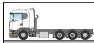
Tracteur Scania Série R pour transport exceptionnel, acceptant jusqu'à 250 tonnes de poids total roulant, équipé d'une transmission automatisée Scania Opticruise standard à embrayage automatique standard. Le véhicule est propulsé par un moteur V8 Scania de 16,4 litres développant un couple de 3 500 Nm.
