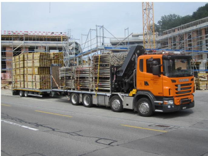
grâce à deux dispositifs d'attelage, même des matériaux de constructions volumineux peuvent être transportés vers et des chantiers.
