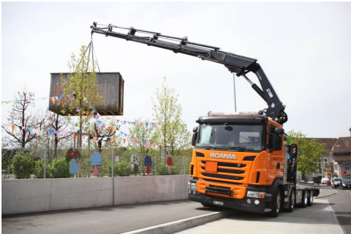
la grue avant puissante de 32 m/t permet de pouvoir soulever des containers de chantiers ou aussi des machines de chantiers à des lieux exposés.
