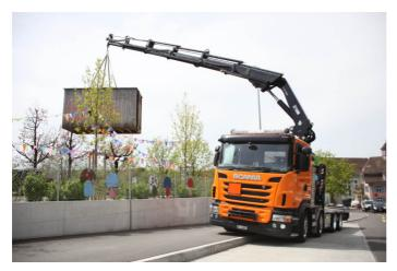
Der leistungsfähige 32 m/t Frontkran ermöglicht es, Baucontainer oder auch Baumaschinen an exponierte Standorte heben zu können.
