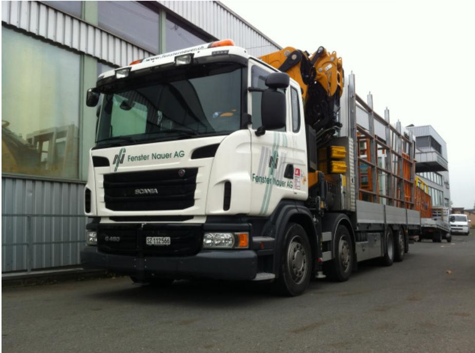
Ausser fliegen kann der neue Vierachser der Fenster Nauer AG aus Samstagen fast alles. Es ist vollluftgedert und verfügt über eine fünffache Abstützung für den Kran.
