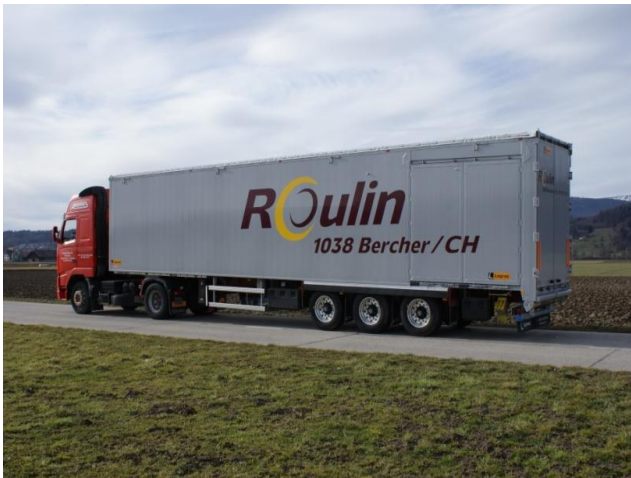
LEGRAS-Schubbodenaufleger, verstärkte Ausführung, 93 m 3
