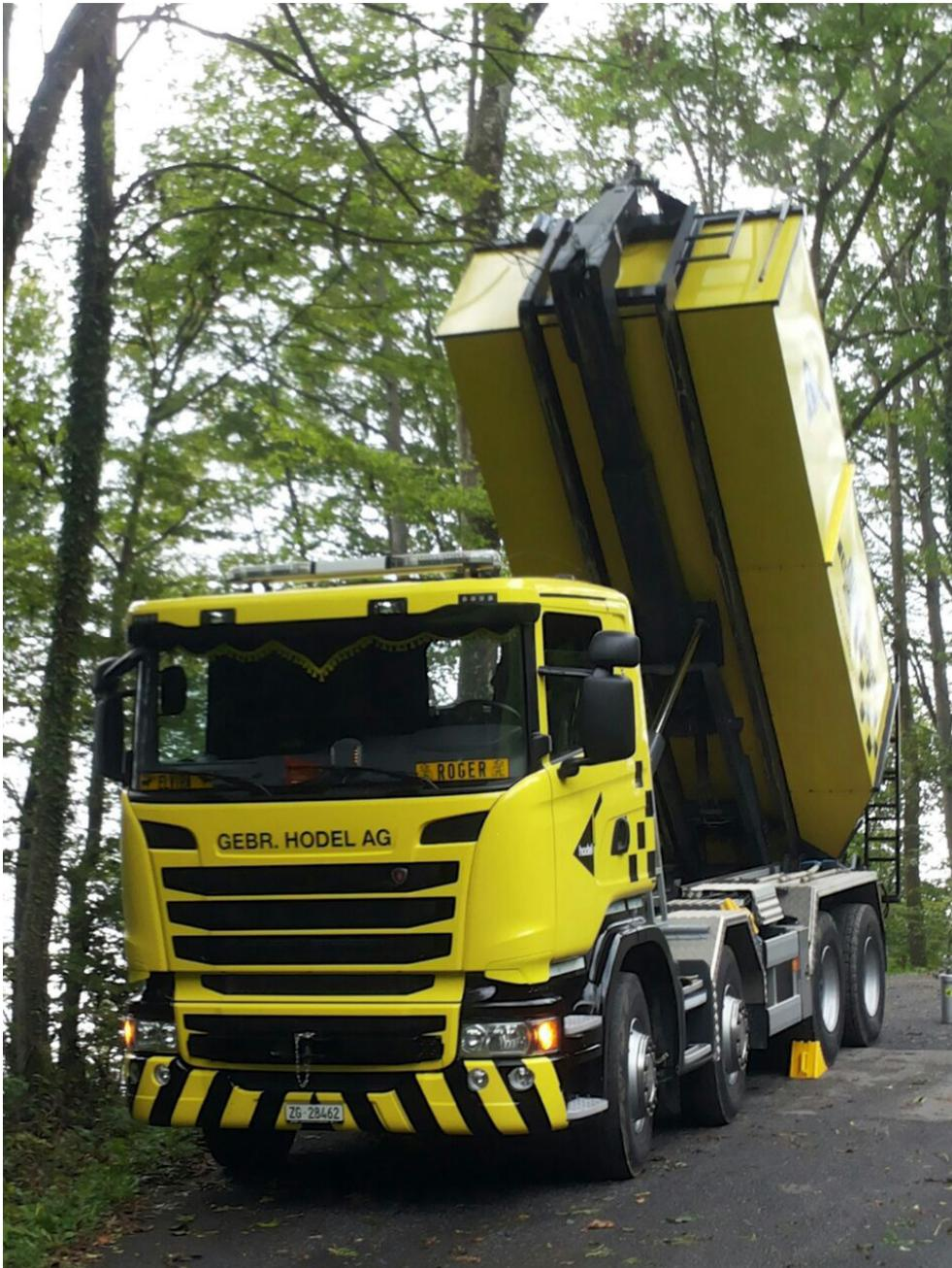
Le nouveau Scania R490 CB 8x4 de Gebr. Hodel AG à Baar avec benne basculée.
