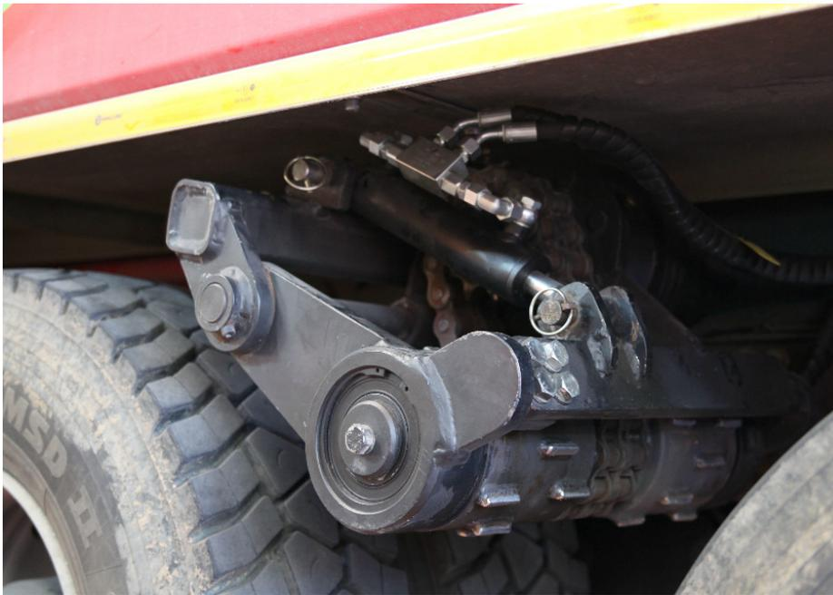
**Bild 5 (7960):** Dank hydraulischem Reib-Rad-Antrieb kann das Fahrzeug im „Schnecken tempo“ von 0 bis 10 km/h angetrieben werden.
