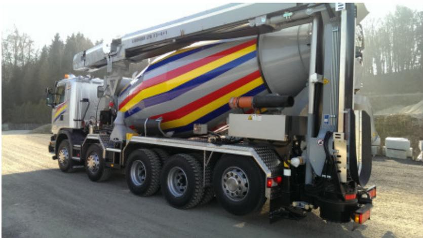
Dank 2-fach teleskopierbarem Förderband können Abladestellen von bis zu 16,2 m erreicht werden. Dank dem tiefen Leergewicht von 20'270 kg können einige hundert Kilogramm mehr Ladung zum nächsten Zielort transportiert werden.
