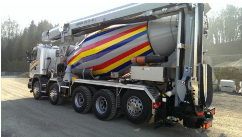
La bande transporteuse télescopique permet d'atteindre des points de déchargement à jusqu'à 16,2 m de distance. Grâce au poids à vide faible de 20'270 kg, le camion peut transporter quelques centaines de kilos de plus à leur destination.
