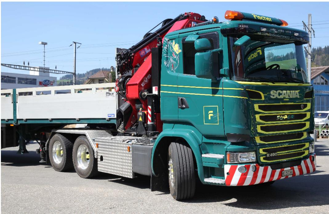
Der Scania R490 LA 6x2 mit 50 m/t Frontkran und einer 10 t Vorderachse ist überwiegend im Emmental und dem Kanton Bern unterwegs.
