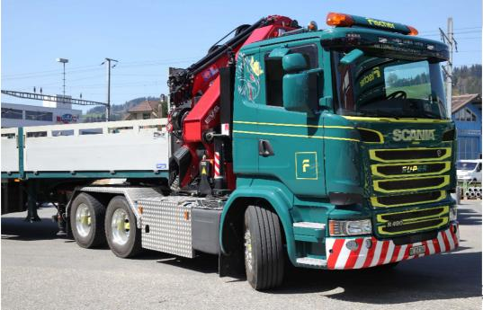
Le Scania R490 LA 6x4 avec une grue frontale de 50 m/t et un essieu avant 10 t circule principalement dans l'Emmental et le canton de Berne.
