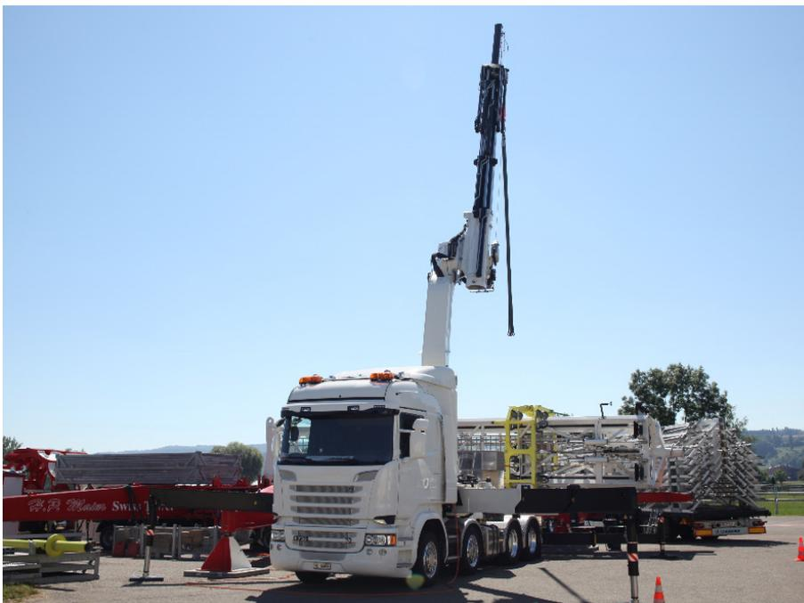
Auch auf einer Höhe von knapp 23 Meter können noch Lasten bis 2'300 Kilogramm gehoben werden.
