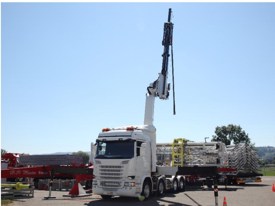
Des charges jusqu'à 2'300 kilogrammes peuvent encore être levées à une hauteur de presque 23 mètres.
