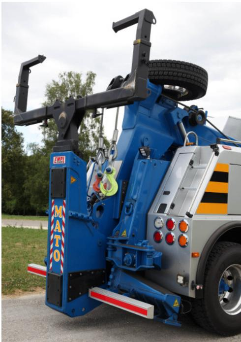
Der leistungsfähige Hebearm mitsamt Brille nimmt jedes Grossfahrzeug, egal ob Lkw oder Bus, problemlos auf.
