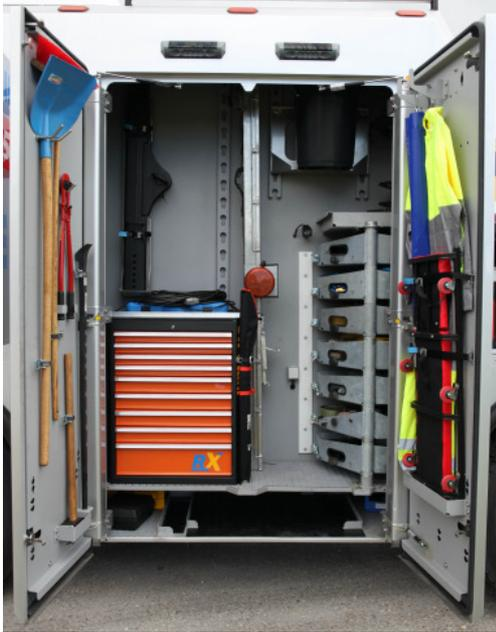
Die komplette Werkstatt ist immer dabei. Rechts (innen) der herausdrehbare Werkbank. Sauber aufgeräumt führt das Fahrzeug eine Vielzahl von Hilfsmitteln und Spezialwerkzeugen mit.
