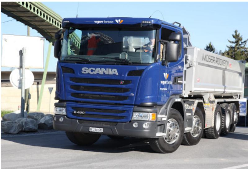
Als einziger der vier neuen Scania verfügt der 5-Achser mit RockBox-Aufbau über den leistungsstärksten 6-Zylinder-Reihenmotor mit 490 PS.
