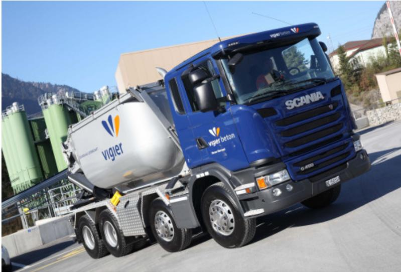
Der Scania G450 CB 8x4 mit dem etwas längeren Radstand von 4'300 mm bekam von der Firma Abatrag einen Meiller Silo-Aufbau aufgebaut.
