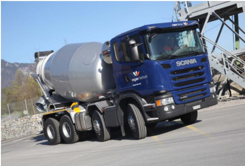
Der „normale“ Scania G450 CB 8x4 Vierachser bekam einen CIFA-Drehmischer aufgebaut.
