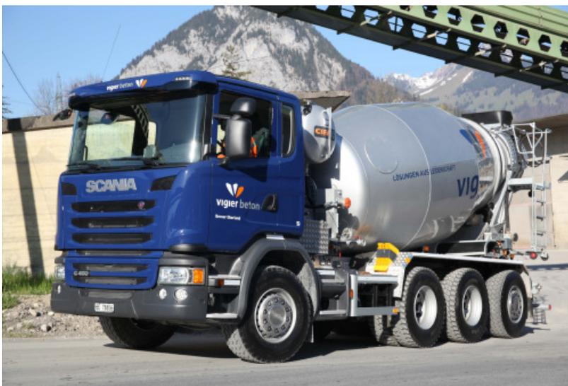
Même le Scania G450 LB 8x4\*4 avec une formule d'empattement 1+3 est muni d'un mélangeur rotatif CIFA.
