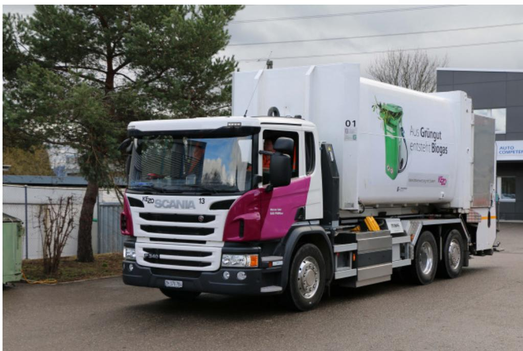
Au premier regard, le Scania P340 LB 6x2\*4 CNG de Werner Isler est une benne à ordures absolument normale. C'est seulement en regardant de plus près que l'on remarque les deux grandes «boîtes» sur le côté du châssis. Derrière ces coffrages se trouvent quatre bonbonnes de 80 kg de gaz de chaque côté.
