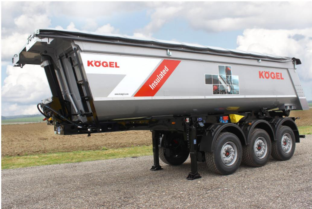
Photo : Semi-remorque à benne pour asphalte à 3 essieux avec un volume de chargement de 24 m<sup>3</sup> de Kögel
