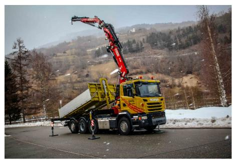
Grâce au concept modulaire de la carrosserie, on peut à tout moment engager la grue adéquate. De la grue à bois de 14 m/t via des grues de 20 m/t, 45 m/t, 48 m/t jusqu'à une grue de 110 m/t. Les clients ont le choix non seulement entre différentes variantes de grues, mais aussi de superstructures, ici par exemple une benne basculante.
