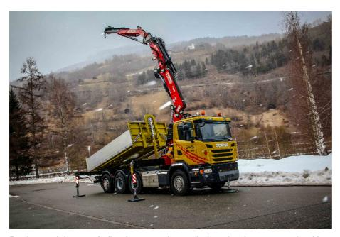
Dank modularem Aufbaukonzept kann jederzeit der passende Kran eingesetzt werden. Vom 14 m/t Holzkran über einen 20 m/t, 45 m/t, 48 m/t bis zum 110 m/t Kran. Nicht nur unter verschiedenen Kranen kann ausgewählt werden, auch bei den Aufbauten, hier z.B. mit Kippbrücke, stehen den Kunden unterschiedliche Varianten zur Verfügung.
