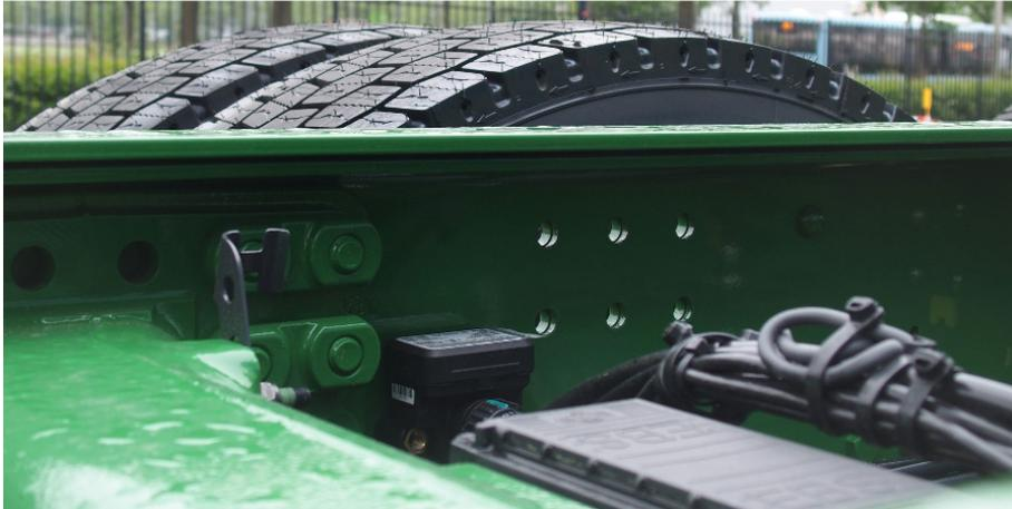
Les doubles supports de cadre garantissent une sécurité maximale, notamment lors du basculement de la benne sur un sol non asphalté et irrégulier.
