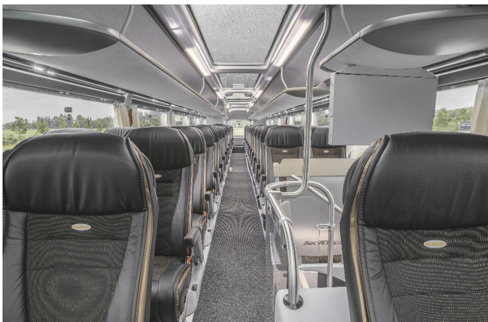
Nel livello superiore dell'autobus a due piani il tetto finestrato quasi continuo e i vetri laterali fino al tetto garantiscono tanta luce e un'ottima visuale.
