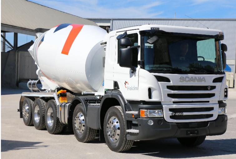
Einer der insgesamt 24 neuen Scania LB 10x4\*6 Fahrmischer im Fuhrpark der Holcim (Schweiz) AG. Dank gelenkter und liftbarer Nachlaufachse sind die neuen Fahrmischer extrem wendig und so auch auf sehr engen Baustellen sehr gut einsetzbar. Über lediglich zwei Trittstufen gelangt der Fahrer in das sehr tief aufgebaute CP16 Fahrerhaus. Die gewählte CP16 Tageskabine bietet dem Fahrer einen optimalen Arbeitsplatz und hervorragende Rundumsicht.
