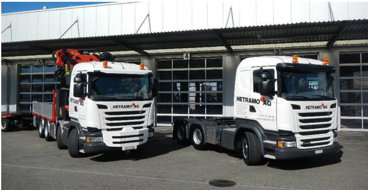
Die beiden ersten Scania im Fuhrpark der Hetramo AG: Links der G490 LB 8x4 mit 92 m/t Frontkran und rechts der G490 LA 6x4.
