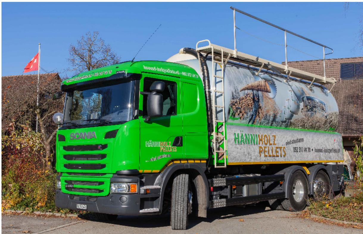
Le Scania G450 LB 6x2\*4 neuf en route vers la prochaine destination. L'essieu porteur relevable et dirigeable permet de desservir sans problème des points de déchargement étroits. Les deux superstructures du véhicule et de la remorque disposent d'un volume de transport de 26 m<sup>3</sup> et de 22 m<sup>3</sup>.
