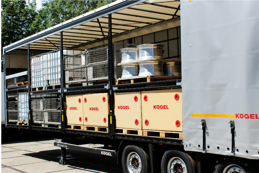
Photo : chargement double étage sur semi-remorque Kögel Mega
