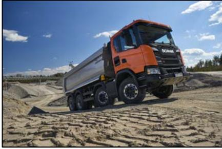
*Mit dem XT stellt Scania ein Modell für härteste Aufgaben vor, für die Robustheit, Produktivität und Verfügbarkeit unerlässlich sind. Der wuchtige Stossfänger weist einen Überstand von 150 Millimetern auf. In Kombination mit der Unterboden-Schutzplatte und dem Scheinwerferschutz ist die Fahrzeugfront bestens geschützt.*
