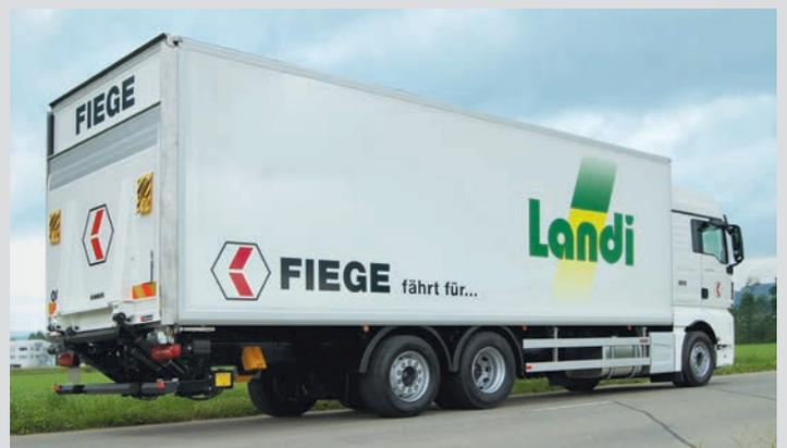
Koffer-Aufbau mit Hebebühne für den Verteilerverkehr.
