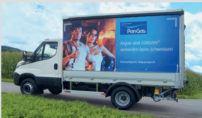
SideCurtain-Aufbau auf Transporter mit Hebebühne, Seitenladen und Lüftungssystem.
