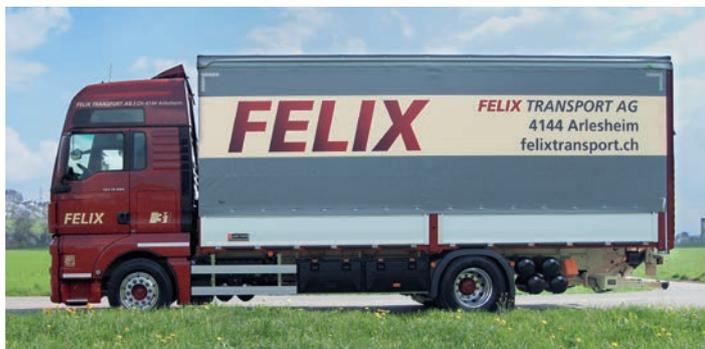
Motorwagen mit LANZ+MARTI SideCurtain-Aufbau, Seitenladen und Hebebühne.
