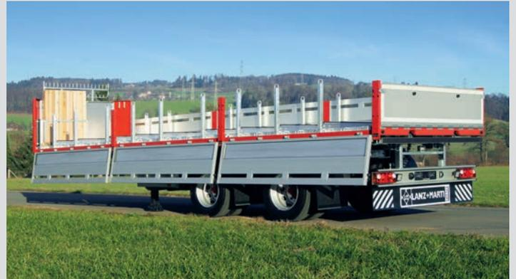
2-Achs-Sattelaufleger mit hydraulisch gelenkten Achsen, gemacht für jeden Kreisel.
