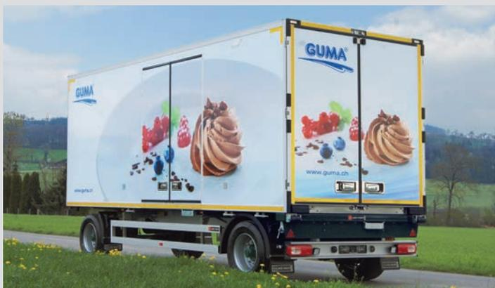
2-Achs-Anhänger mit Kühlkofferaufbau, Heck- und Seitentüren.
