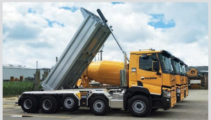
Schnellwechselsystem für Rückwärtskipplade und Fahrmischer für den flexiblen Baustelleneinsatz.
