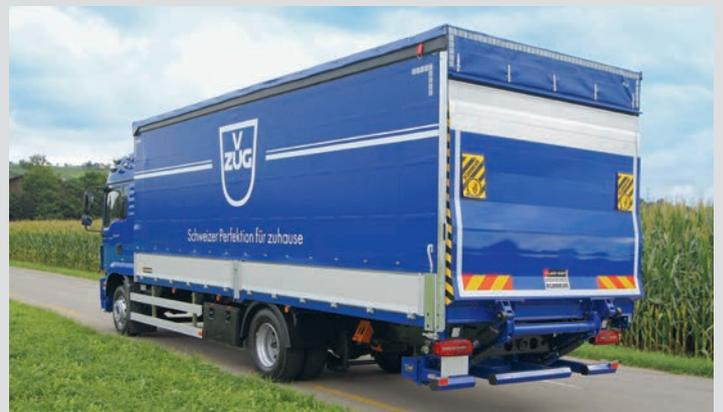
SideCurtain-Aufbau mit Hebebühne und Seitenladen.
