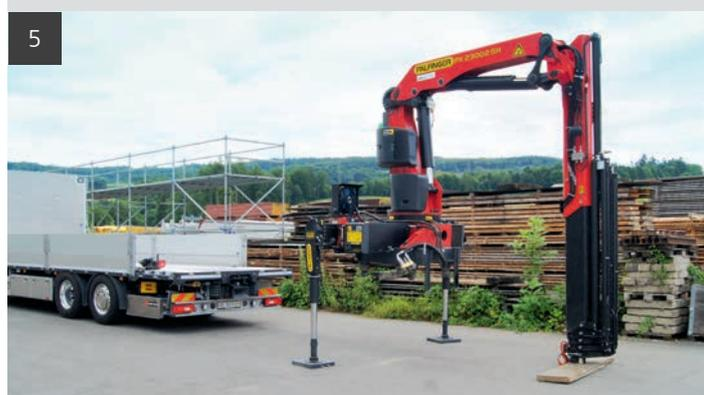
sätzliche Fahrten. Bei LANZ+MARTI AG haben sich Mitarbeiter also die Aufgabe gestellt, ein System zu entwickeln, das es ermöglicht, den Kran nach Wunsch zu demontieren und beiseite zu stellen. Dies sollte ohne schmutzige Hände und ohne Einsatz von Werkzeug oder anderen Hilfsmitteln möglich sein. Gleichzeitig sollte die Brücke um die Kranfläche rasch und einfach erweitert werden können.
