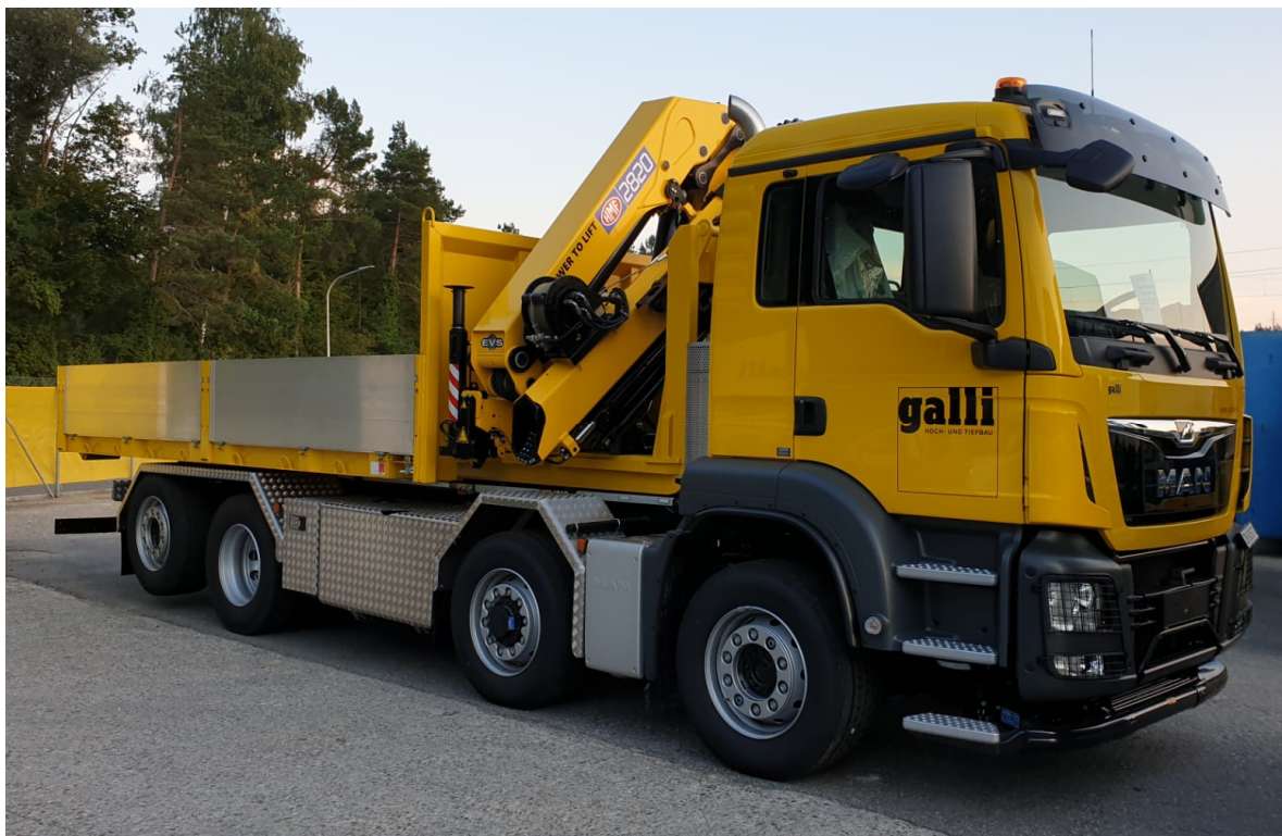
Illustration 2: Une prestance qui en impose: le TGS 37.500 8x4H-6 BL avec bras de manutention et grue de chargement HMF 2820 K6.
