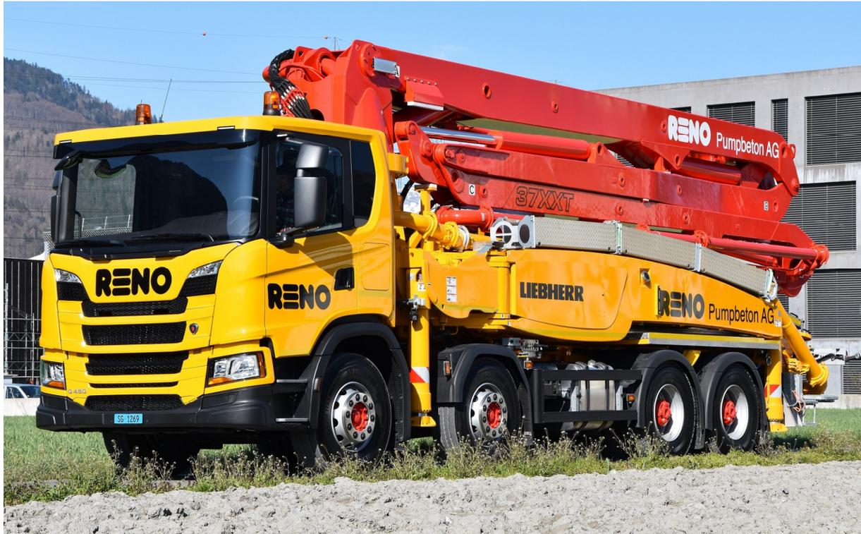
Das Jubiläumsfahrzeug der Reno Pumpbeton AG in Maienfeld. 8x4 Fahrgestell mit tiefem G-Fahrerhaus. Liebherr-Autobetonpumpe 37 Z4 XXT
