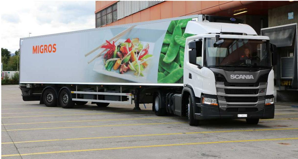
Der erste CNG-Scania der Genossenschaft Migros Basel ist eine G410 A 4x2 NA Sattelzugmaschine. Links und rechts am Fahrgestell sind je vier Stahltanks mit einem Fassungsvermögen von je 95 kg Biogas verbaut.
