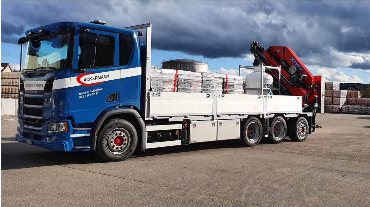
Fertig beladen und gesichert, um die nächste Baustelle termingerecht beliefern zu können. Dank zwei angetriebenen Hinterachsen auch abseits von befestigten Strassen sicher unterwegs.
