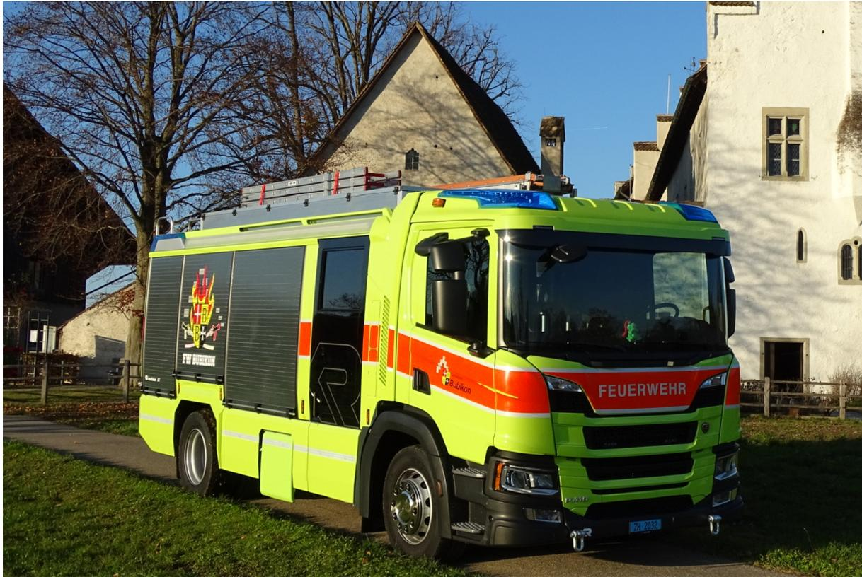
Das neue TLF der FW Bubikon wurde auf einem Scania P410 B 4x2 NB realisiert. Kompakt, möglichst tief konzipiert und realisiert. Die Mannschaftskabine wurde durch die Firma Rosenbauer elegant in den Aufbau integriert.
