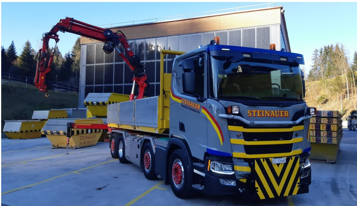
Unterwegs mit offener Brücke und Heckkran können Lasten dort auf- oder abgeladen werden, wo ein Stapler nicht hinkommt. Der neue Scania R500 B
