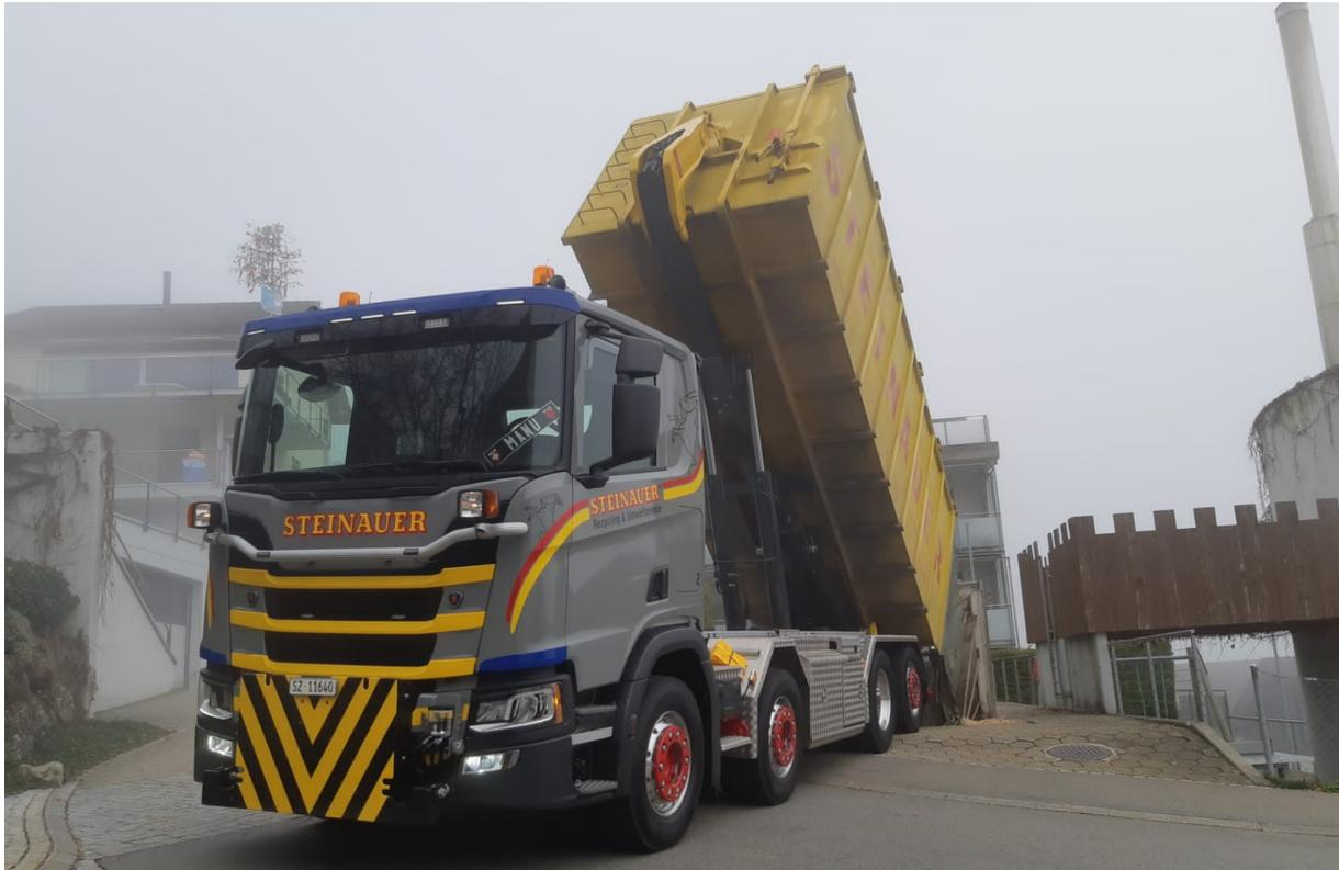
Das Hakengerät lässt den neuen Scania auch zum Kipper werden.
