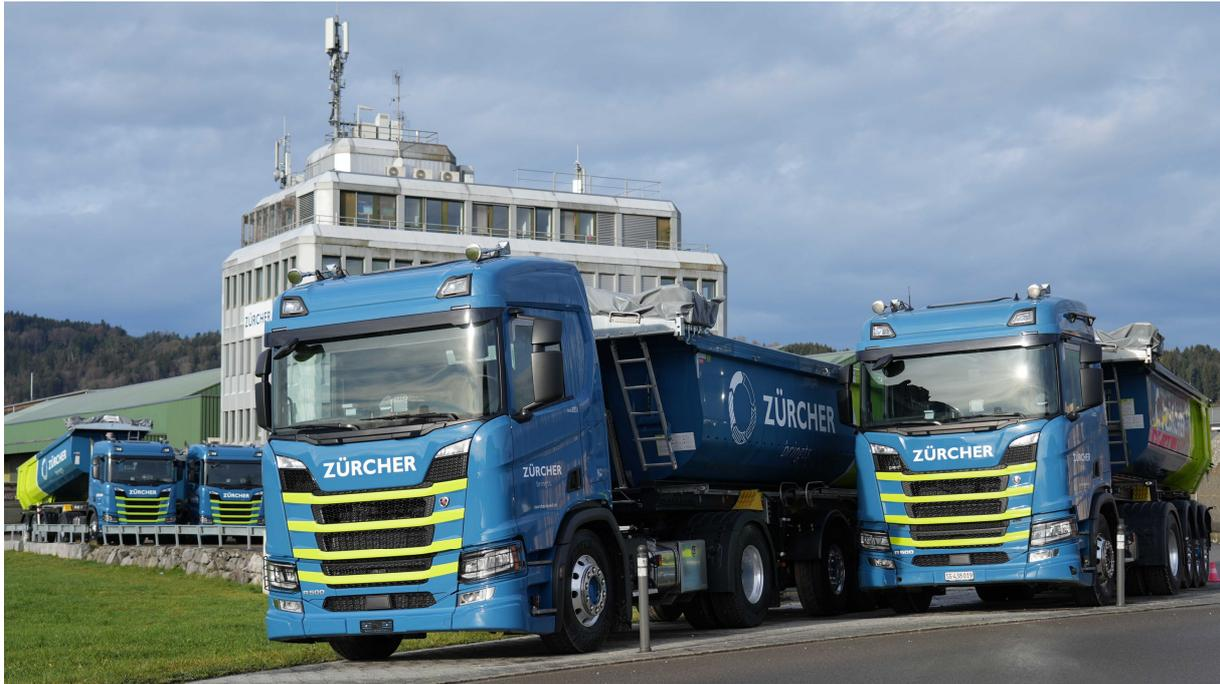
Zwei der neuen 4x2 Sattelzugmaschinen, welche am 3-Achs-Kippaufleger über eine hydraulisch angetriebene 2. Achse verfügen.
