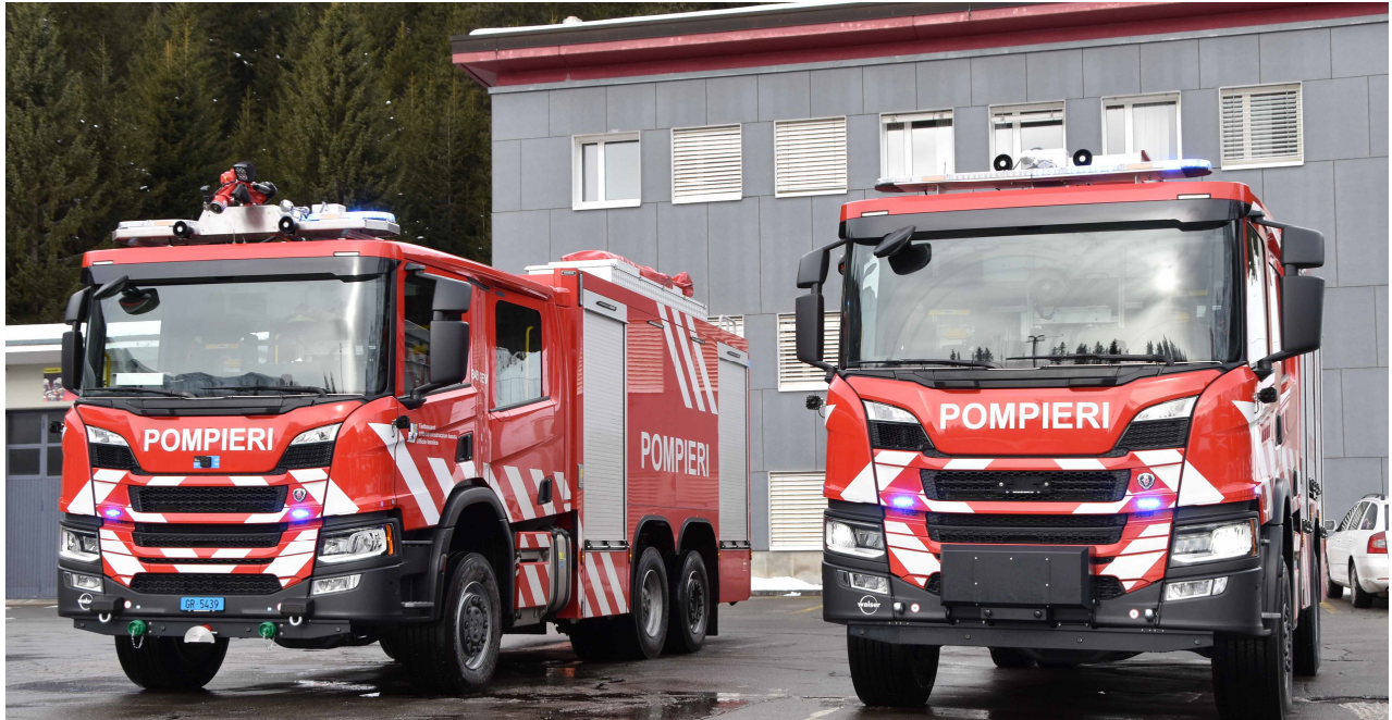
Die beiden neuen Scania Fahrzeuge der Schadenwehr San Bernardino. Links der Gross-Tanklösch-Fahrzeug Scania P500 B 6x4*4 HA und rechts das Universallösch-Fahrzeug auf der Basis eines Scania P410 B 4x4 HA.
