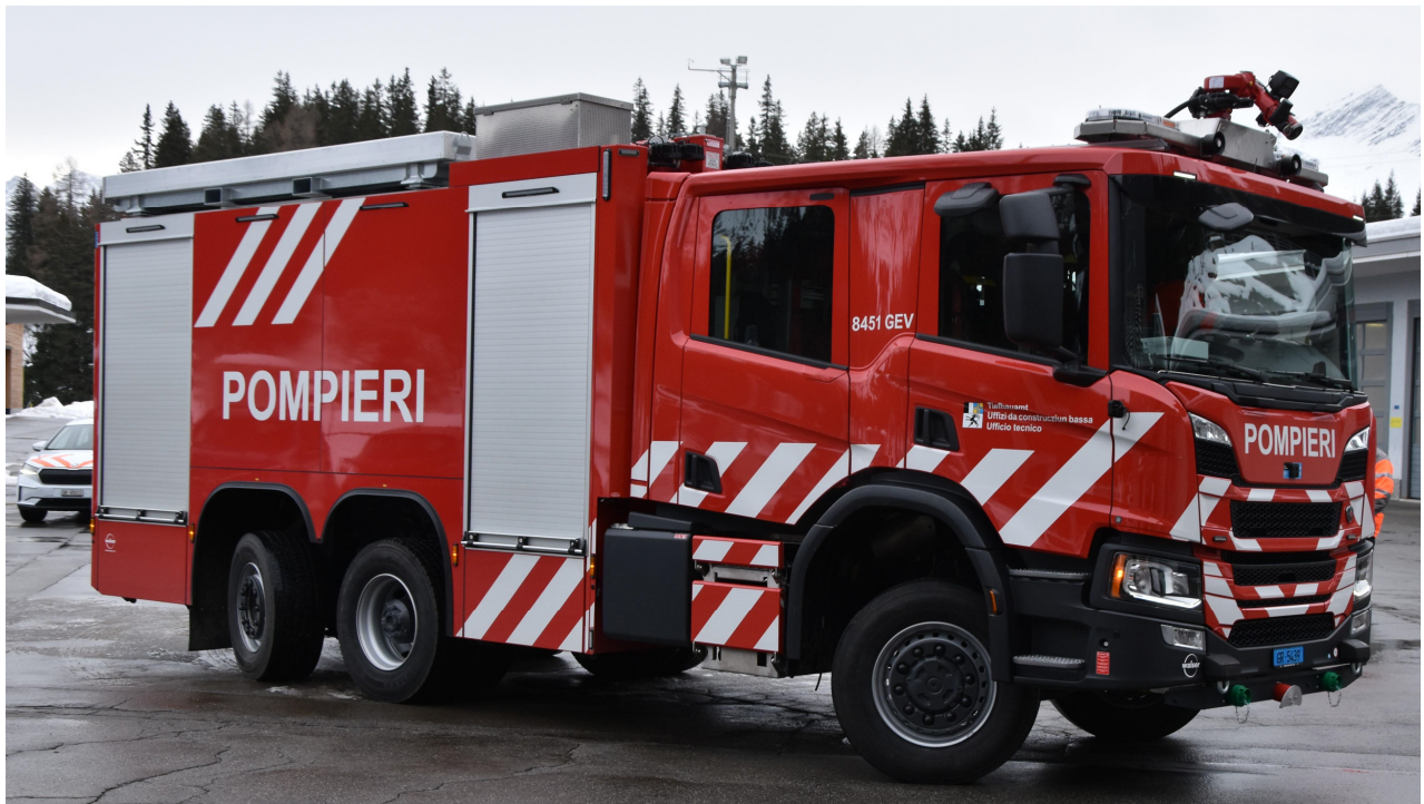
Dank lenk- und im leeren Zustand liftbarer Nachlaufachse ist der Scania P500 B 6x4*4 HA äusserst wendig.
