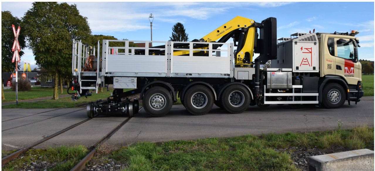
Préparation pour la prochaine mission sur le réseau ferroviaire. Une fois le système rail-route déposé, le châssis du camion peut être soulevé et, en la tournant à 90°, la deuxième partie peut également être placée sur le réseau ferroviaire.
