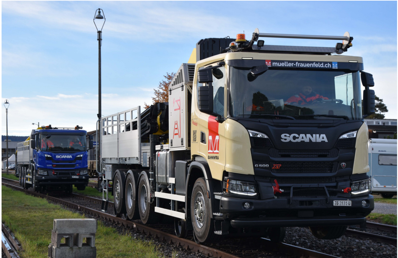
Les deux véhicules rail-route sur la base d'un châssis Scania G500 B 8x4*4 NZ.
