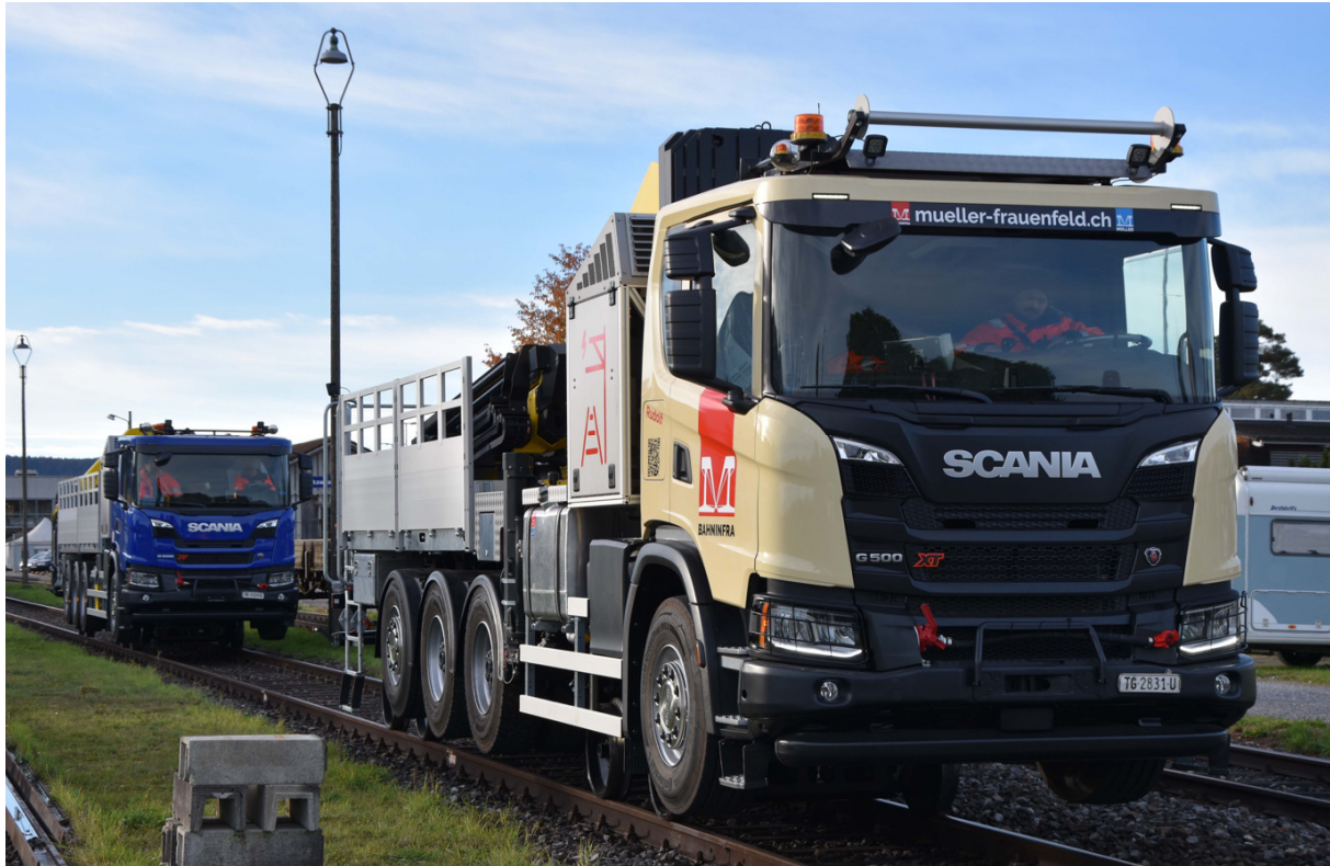
Die beiden 2-Wege-Fahrzeuge auf der Basis eines Scania G500 B 8x4*4 NZ Fahrgestells.
