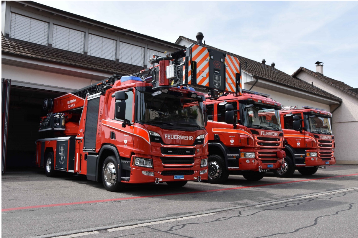
Die Feuerwehr Dornach vertraut auf Scania Basis-Fahrzeuge; v.l.n.r. P360 B 4x2 ADL Jg. 2023, P360 CB 4x4 Rüstfahrzeug Jg. 2018 und ein P360 CB 4x4 TLF
