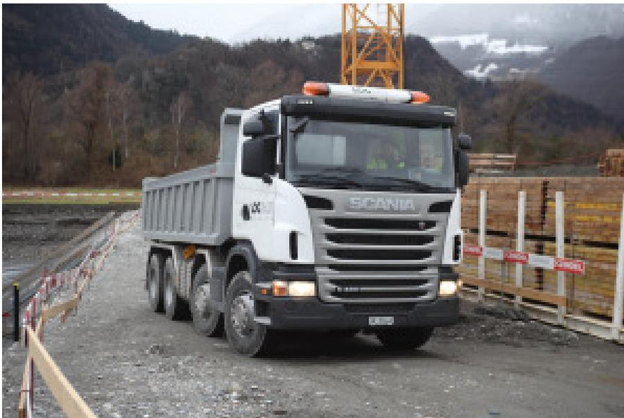
Qu'il s'agisse d'une superstructure à mélangeur rotatif ou d'une benne basculante, les différentes superstructures peuvent être échangées rapidement et efficacement grâce au système interchangeable.
