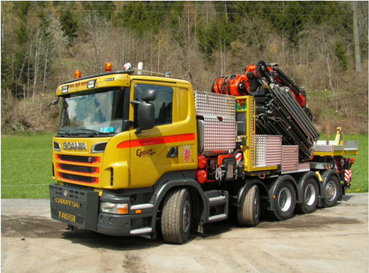
Das neue imposante Kranfahrzeug ist ein Fünfachser Scania R620 LB 10x4\*6 HNA 35 Euro 5 SCR mit nachgerüsteter elektrohydraulischer Vorlaufachse, gelenkter Nachlaufachse und 3.5 m Radstand.
