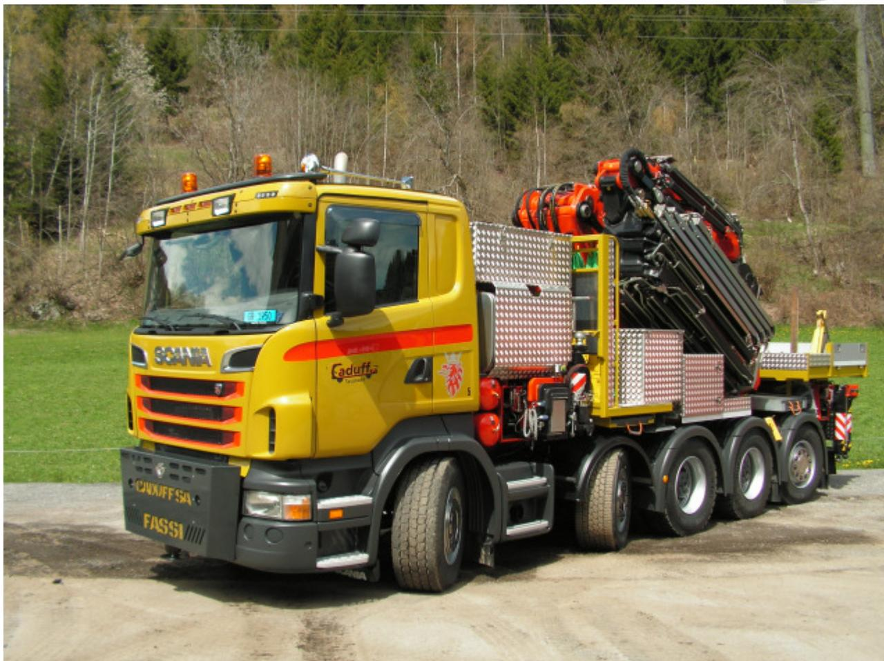
Le nouveau véhicule à grue imposant est un Scania R620 LB à cinq essieux 10x4\*6 HNA 35 Euro 5 SCR avec essieu de guidage électrohydraulique rééquipé, un essieu porteur orientable et un empattement de 3.5 m.
