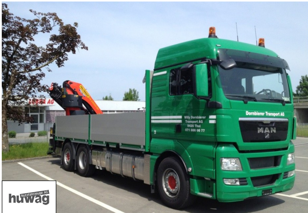
MAN TGX 26.480 6x2-4 LL von der MAN Vertretung huwag Nutzfahrzeuge AG Mörschwil mit PALFINGER PK 23002 SH gebaut von der August WELTE GmbH für die Willy Dornbierer Transport AG, Thal und Rorschacherberg
