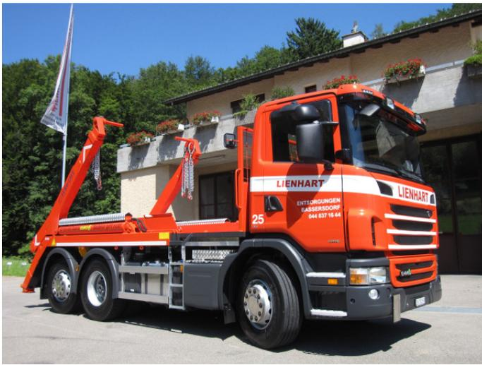
Dank lift- und lenkbarer Nachlaufachse ist der grosse Welaki äusserst wendig und kann so Mulden verschiedenster Grössen an fast jeden beliebigen Standort stellen.
