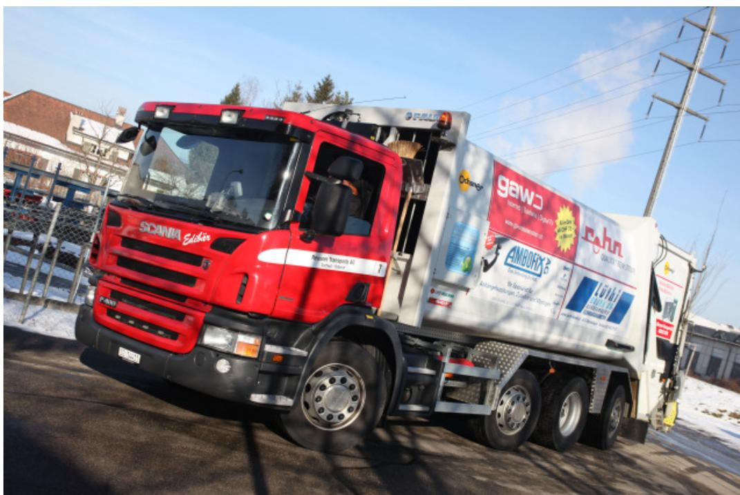
Das neue Fahrzeug im Fuhrpark der Reusser Transporte AG ist ein Scania P400 LB 8x2\*/6. Dank lift- und lenkbarer Vor- und Nachlaufachse ist das Fahrzeug trotz optischer Täuschung wendiger als manches Dreiachsler-Fahrzeug.
