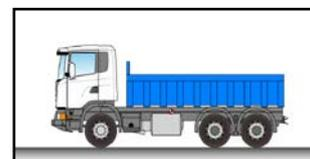
Komplett ab Werk ausgestattet beträgt das Gesamtgewicht (GG) dieses 16-Kubikmeter Drei-Achser-Kippers 39 Tonnen, die Nutzlast robuste 24 Tonnen. Hohe Ladekapazität und außergewöhnliche gute Fahrbarkeit machen diesen Lkw zu einer flexiblen Alternative zu Dumpfern. Auch verfügbar als 8x4 mit GG von 56 Tonnen. Mehr als 4.000 dieser 6x4 oder 8x4 Kipper wurden bisher in Europa und Asien ausgeliefert.
