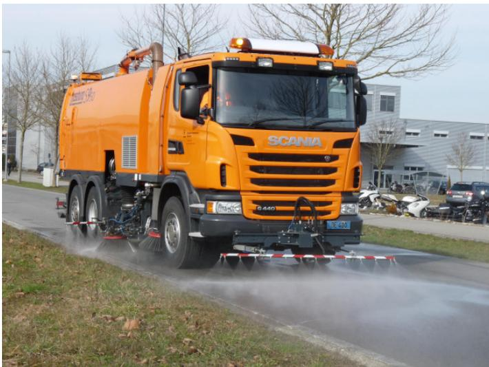
Eine Spezialität aus dem Hause Scania, der Scania G440 LB 6x2\*4 mit hydrostatischem Fahrtrieb.
